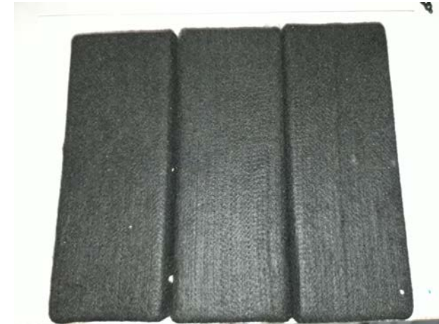
Aspecto de la muestra antes del ensayo de inflamabilidad según EN ISO 11925-2 (aplicado en borde)
