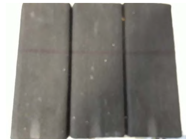
Aspecto de la muestra tras del ensayo de inflamabilidad según EN ISO 11925-2 (aplicado en borde)
